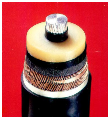
Figur 10. Markkabel, innerst en ledare av aluminium med svart tätning, sedan en gulaktig isolation av PEX, följt av ett lager koppartråd och ytterst ett skyddshölje av polyeten
